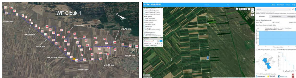
Slika 2. VE „Čibuk 1“: raspored VG i srednje godišnje brzine vetra (levo) i izveštaj GWA za VT7 (desno)
